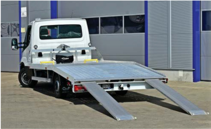
▶ Platforma EPS4VA firmy Blyss jest przystosowana do transportu samochodów o masie do 1600 kg.
